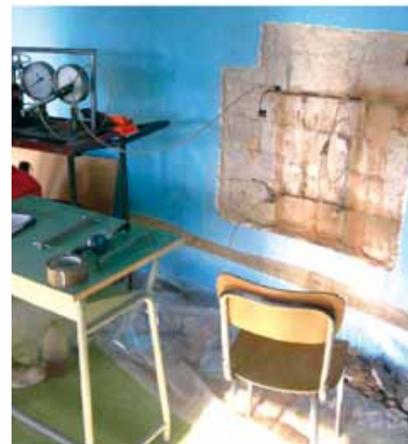
Prove sui materiali: Flat jack test su muratura
